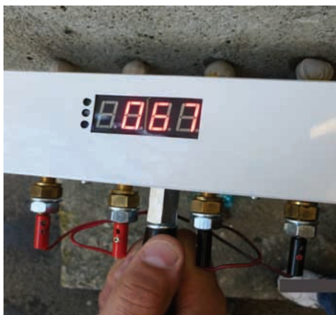
Fig. 3. Măsurarea rezistivității unui stâlp de beton din incinta INCDIE ICPE-CA, prima măsurătoare.
