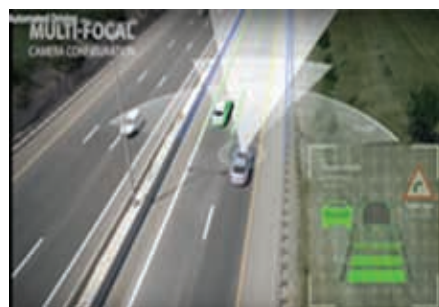
Fig. 7 Informația tipică procesată într-o imagine captată de un sistem de vedere a vehiculului
