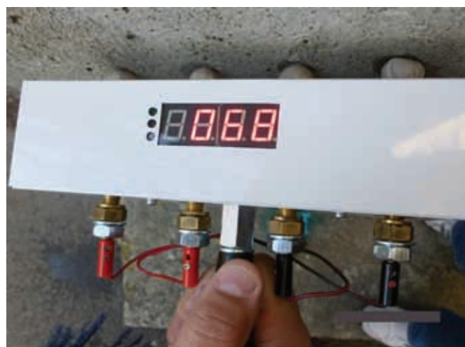
Fig. 4. Măsurarea rezistivității unui stâlp de beton din incinta INCDIE ICPE-CA, a doua măsurătoare.
