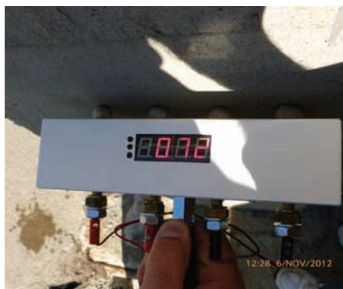
Fig. 6. Măsurarea rezistivității unui al doilea stâlp de beton din incinta INCDIE ICPE-CA, a doua măsurătoare.
