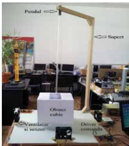
Figura 1.1. Modelul fizic al sistemului de poziționare
