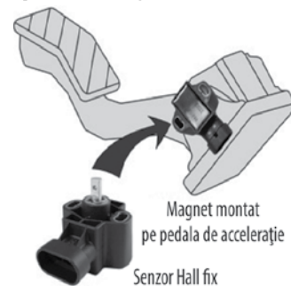
Fig. 4. Senzor de poziție Hall folosit la determinarea deplasării unghiulare a pedalei de accelerație
